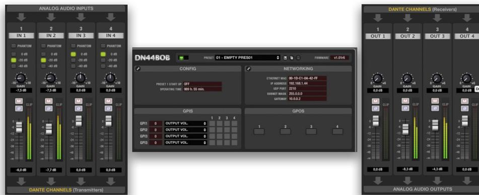
**DN44BOB** es una interfaz de audio sobre IP que emplea el protocolo Dante™/AES67, que permite convertir 4 señales de audio analógicas MIC/LINEA en 4 canales DANTE para su transmisión vía red Ethernet, así como la recepción de 4 canales DANTE desde la red Ethernet y su conversión en señales de audio analógico y nivel LINEA.
