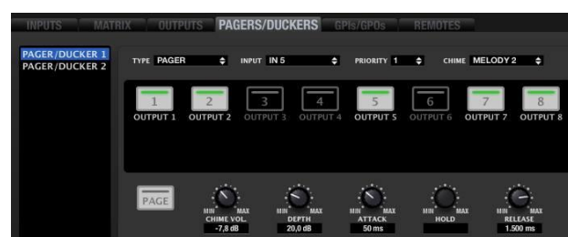
Detalle de la sección PAGERS/DUCKERS, desde la que se configura la funcionalidad de una unidad MPAGE16 conectada al sistema
