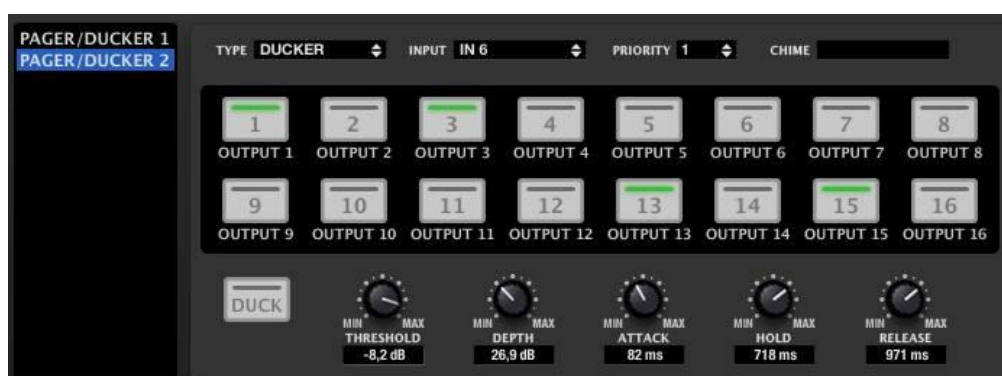
Ejemplo del módulo nº2 configurado como DUCKER, entrada de audio en IN6 y zonas 1, 3, 13 y 15 habilitadas para difundir la señal IN6 como prioritaria cuando ésta supera el umbral, atenuando el contenido sonoro existente en las salidas afectadas
