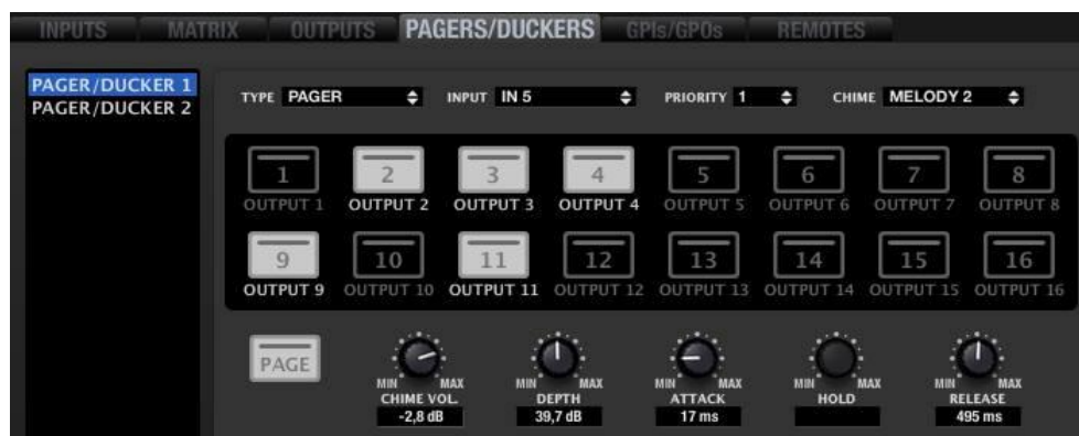
Ejemplo del módulo nº1 configurado como PAGER, entrada de audio en IN5 y zonas 2, 3, 4, 9 y 11 habilitadas para envío de mensajes desde una consola eMPAGE / MPAGE16
