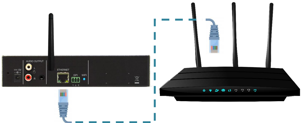
Figura 14 : ejemplo de conexionado a través de la interfaz de red Ethernet (cable)
